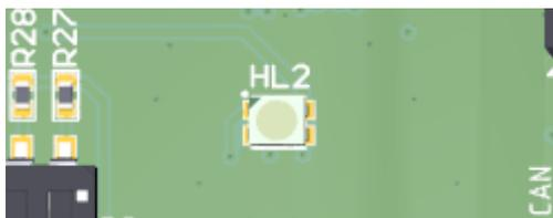
Яркостью свечения каждого светодиода HL2 возможно управлять с помощью ШИМ, генерируемым TMR2 для зелёного и TMR3 для красного и синего.
